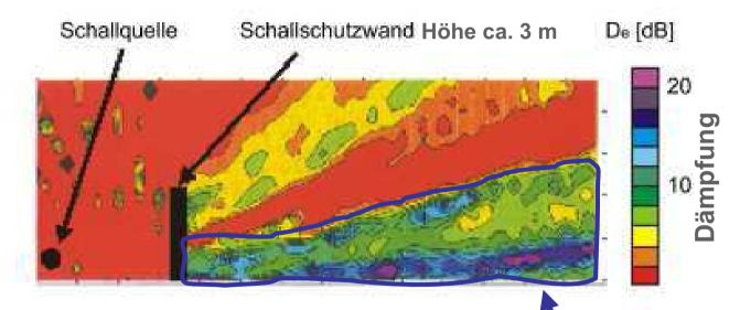
Einfügungsdämpfung De einer quellseitig absorbierend ausgeführten Schallschutzwand, Messung im Modellmaßstab 1:3,
